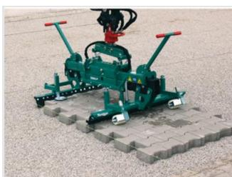
Garfos de fixação na garra multi-blocos para assentar camada sobre camada
